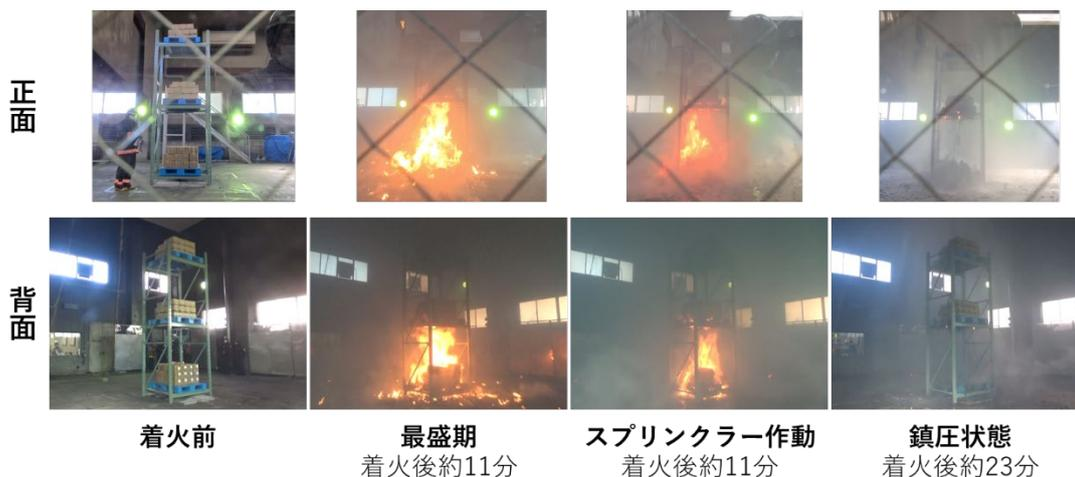
図 3-11 消火実験②の実施結果
