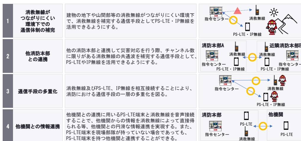
図 4-10 IP無線・PS-LTE と消防救急デジタル無線の連携のユースケース（例）
