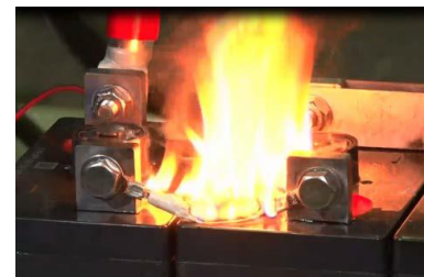
電線発火状況
