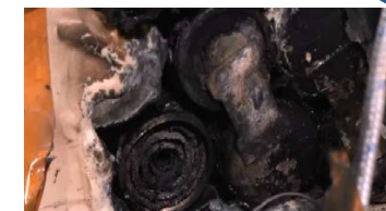
実験後（排出弁の破損状況）
