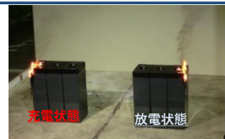
8 mmの電線による接続
