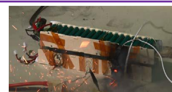
排出弁作動（風圧で消火）
