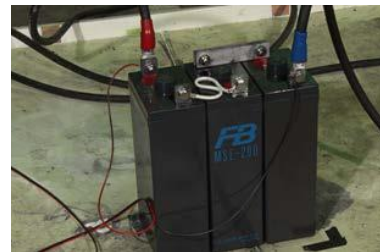
8 mmの電線による接続
