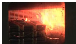
隣接蓄電池への延焼状況
