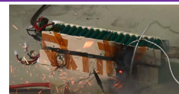
排出弁作動（風圧で消火）
