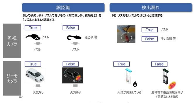
図 4-7 誤認識と検出漏れのイメージ
