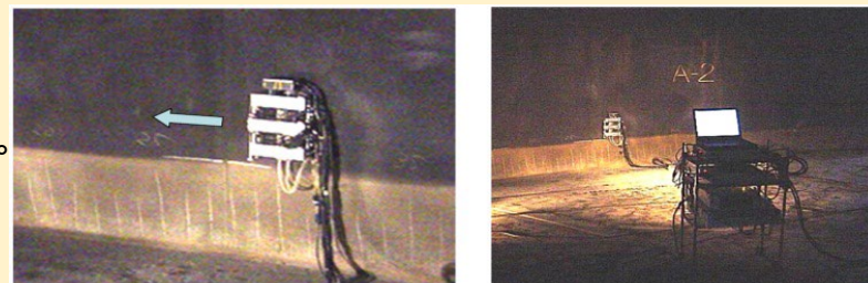
写真3－タンク内面から行う連続的な板厚測定
