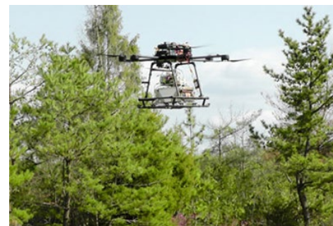
飛行試験中のSOFCドローン
