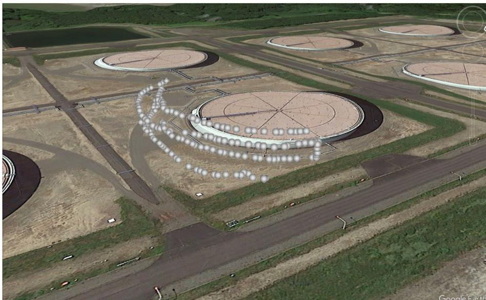
図 3-20 自律飛行によってタンクの側面を自動撮影した際の撮影ポイント
