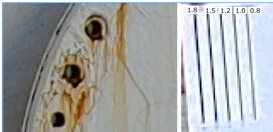
4.2mから撮影した錆と幾何学模様 ※単位：mm (検出基準1.2mmの場合に条件を満たす距離)
