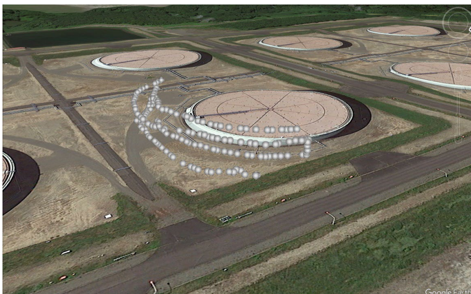
図 3-20 自律飛行によってタンクの側面を自動撮影した際の撮影ポイント
