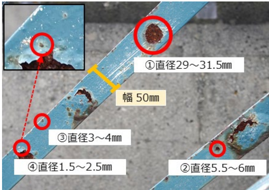
図 3 - 7 検証に用いた実腐食と各腐食の寸法（撮影距離 1m、6, 100 万画素）
