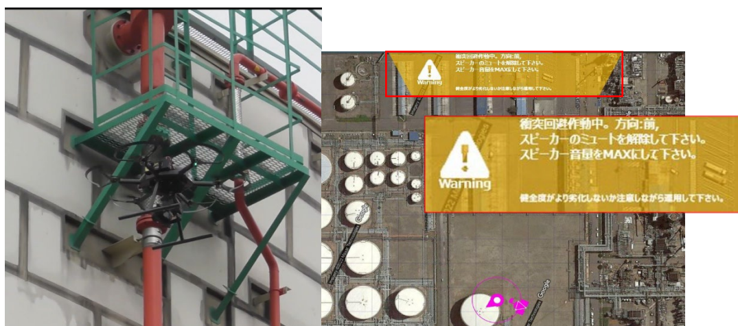
図3-4 衝突回避機能作動確認時の状況
