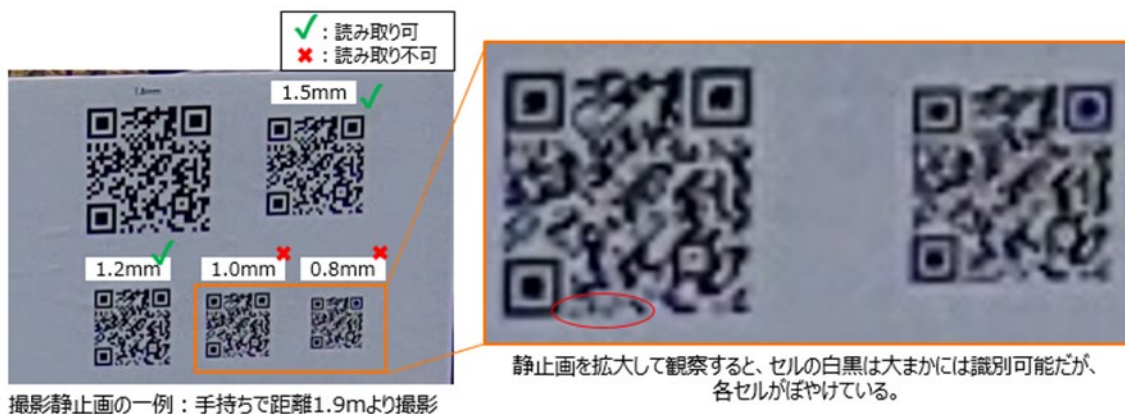
図 3-28 機械読み取りが不可となった QR コードの見え方
