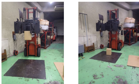
図6-6 落下試験（底面落下）の実施状況（左から落下前、落下後）
