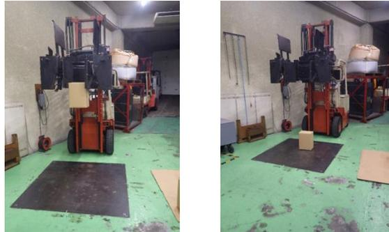
図3-6 落下試験（底面落下）の実施状況（左から落下前、落下後）
