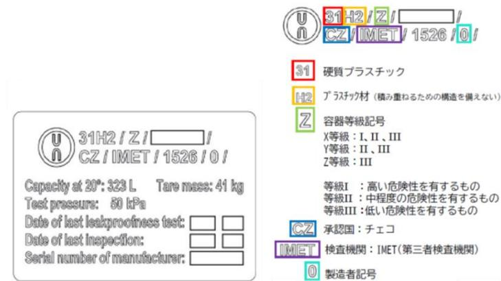
図 2-4 給油機器と一体となった構造の運搬容器のUN表示とその説明
