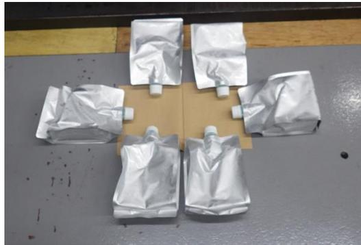
図3-7 内装容器の落下試験後の状況（底面落下）
