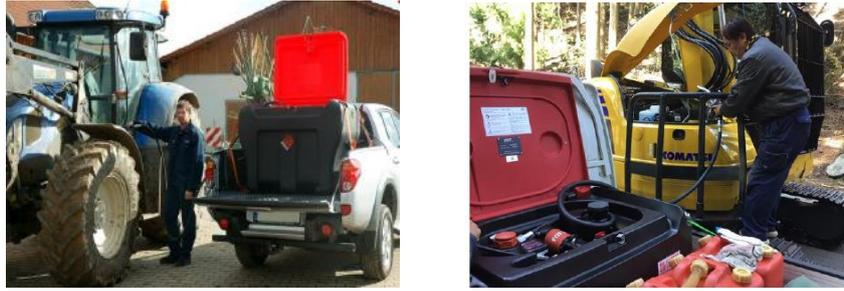
図 2-5 給油機器と一体となった構造の運搬容器に係る海外及び国内の使用事例
