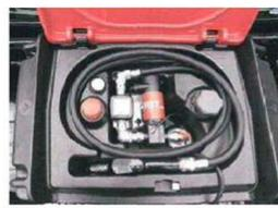
給油ノズル及び給油ホース収納状況
