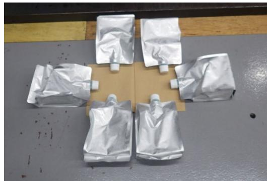
図6-7 内装容器の落下試験後の状況（底面落下）
