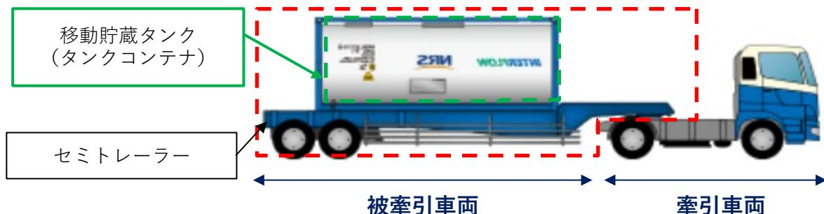
図2-2 (被牽引車形式) 積載式移動タンク貯蔵所の例
