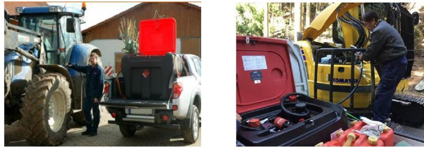
図4-5 給油機器と一体となった構造の運搬容器に係る海外及び国内の使用事例
