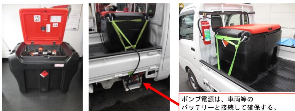
図4－3 給油機器と一体となった構造の運搬容器の使用状況
