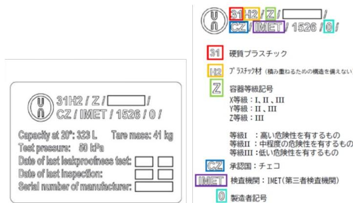
図4-4 給油機器と一体となった構造の運搬容器のUN表示とその説明
