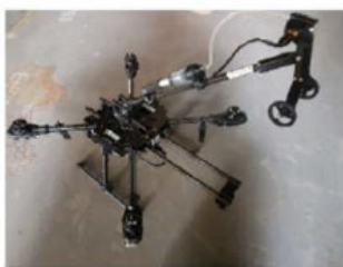
UT Wall drone
