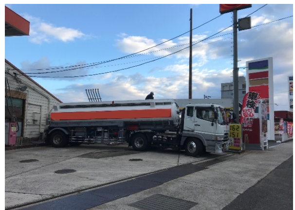
図15 移動タンク貯蔵所による荷卸し作業
