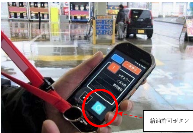
図2 可搬式の制御機器の様子 (給油許可前)
