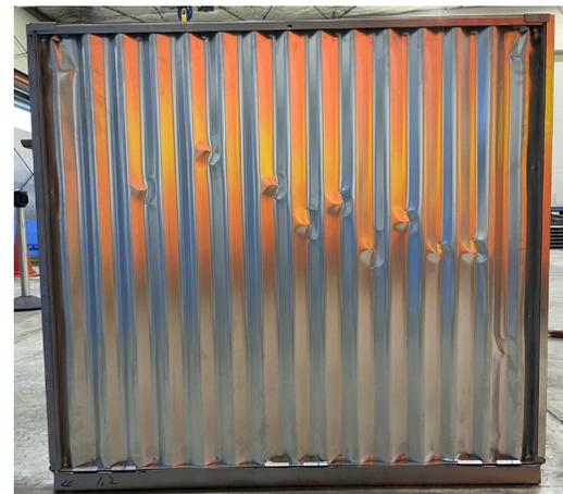
試験後（側板の座屈状況）
