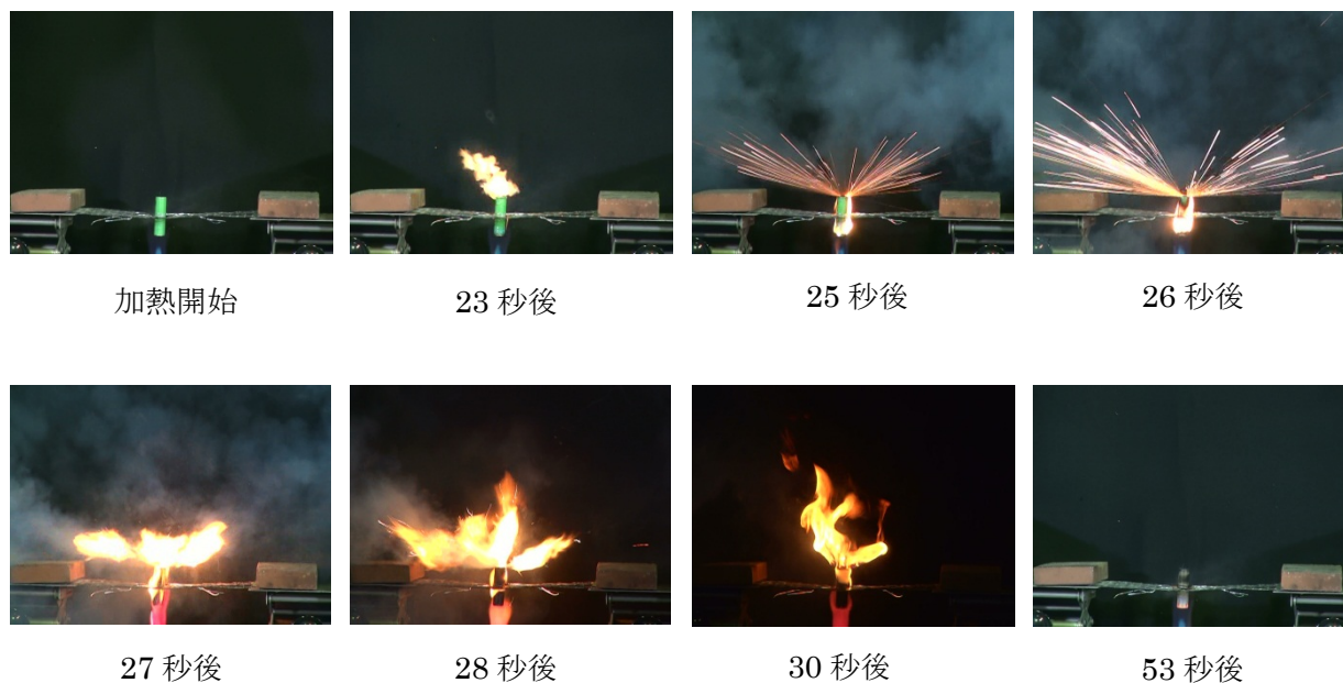
図 7 実験の経過状況（封口後の蓄電池（充電率 50%）） （11/17 に実施した実験のもの（1 回目））
