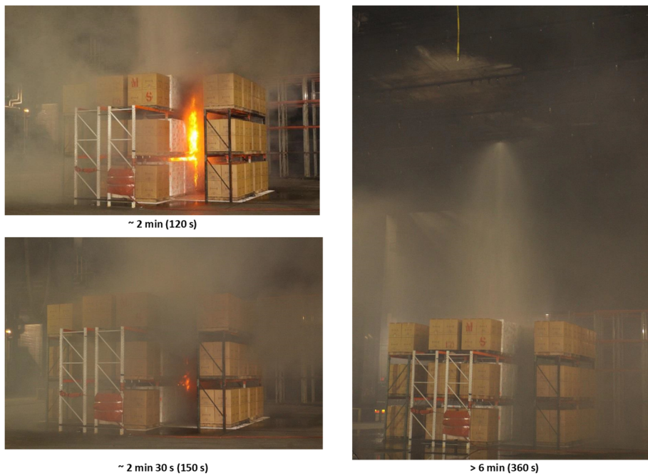
図表・写真 10 スプリンクラーの作動状況 14
