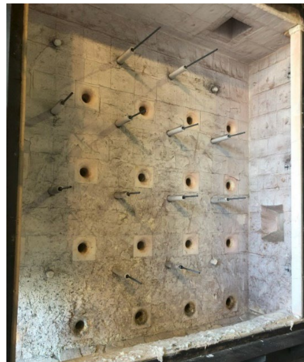
火炎吹出し口の外観 (飛出し部は、火炎面の熱電対)
