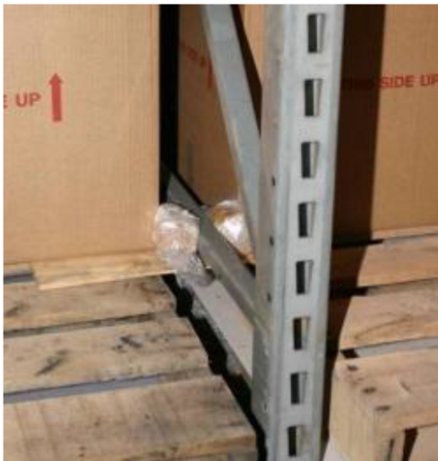
図表・写真 8 点火装置の取り付け状況
