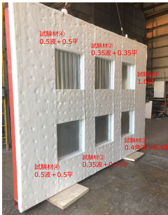
試験用サンプル扉 (火炎側)
