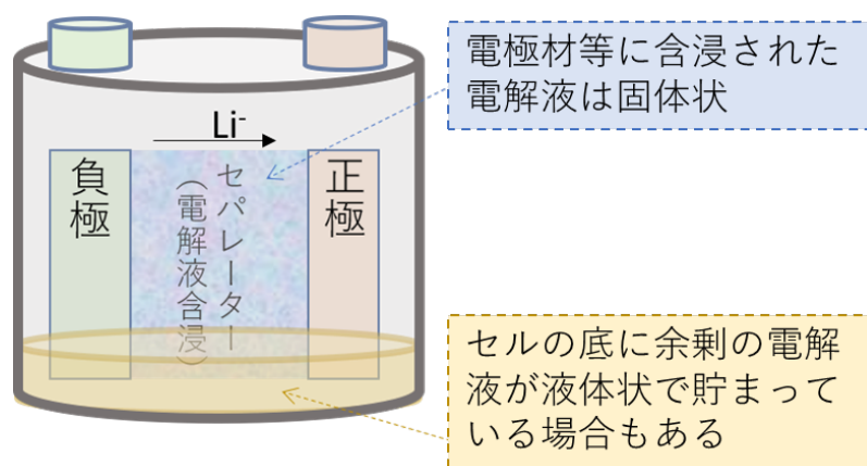
図 5-2 リチウムイオン蓄電池の電解液が電極材等に含浸している状態のイメージ
