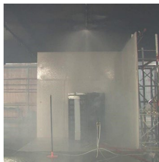
スプリンクラー設備による鎮圧後の様子
