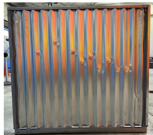
試験後（側板の座屈状況）
