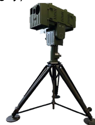
スタンドオフ パッシブ型赤外分光分析装置 (MESH社製 iMCAD) ( S.T.JAPAN社HPより)
