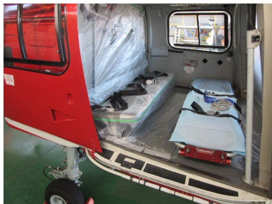
3. ストレッチャーの養生
