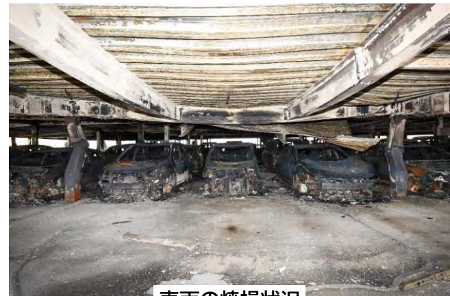
車両の焼損状況
