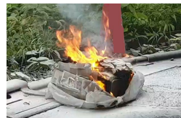
ゴミ袋内の充電式電池（ポータブル電源）から出火した事例 (東京消防庁HPより引用)
