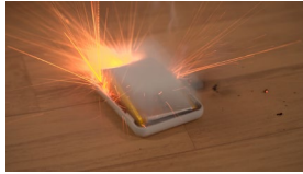
モバイルバッテリー火災の再現映像
