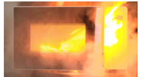
電子レンジ（庫内）火災の再現映像
