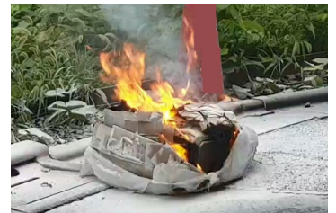
ごみ袋内の充電式電池（ポータブル電源）から出火した事例 (東京消防庁HPより引用)
