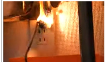
プラグがショート（トラッキング現象）し火災に至る再現実験の様子
