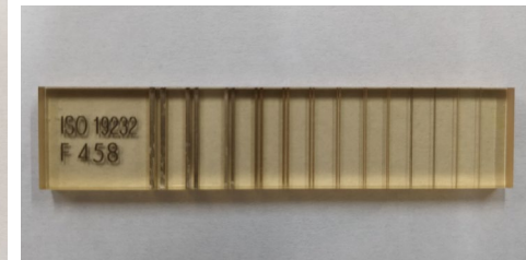
写真-針金形透過度計 (左) と複線形像質計 (右)
