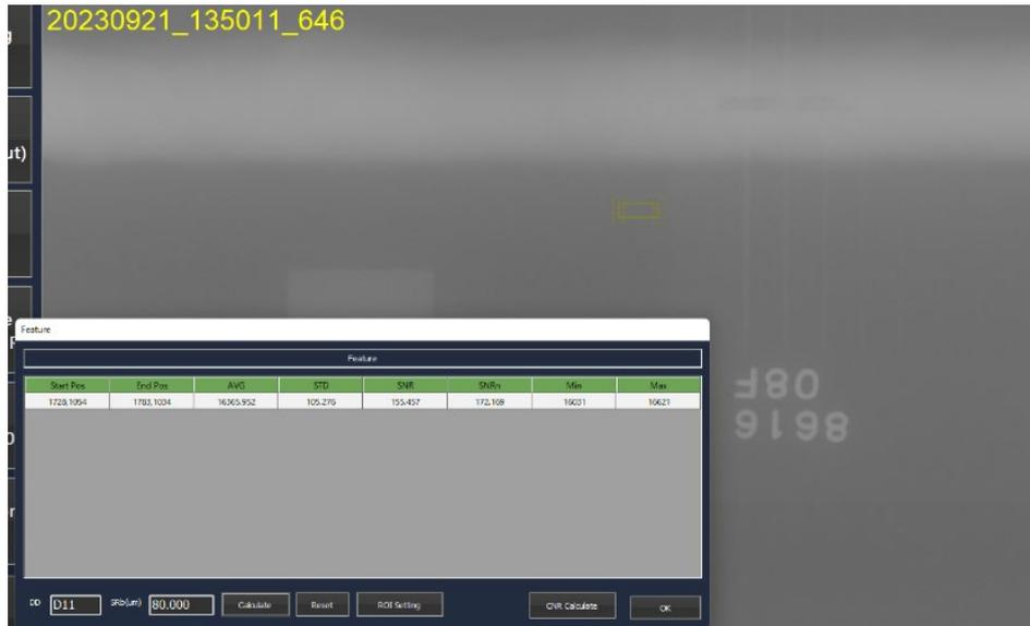
TP-2 板厚20.0mm D-RT (DDA) SNR<sub>N</sub>測定
