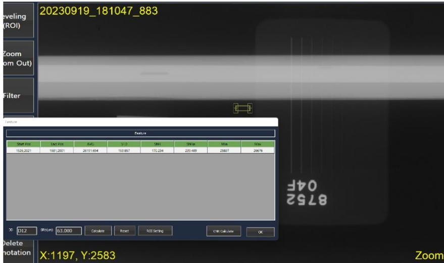
TP-1 板厚4.5mm D-RT (DDA) SNR<sub>N</sub>測定
