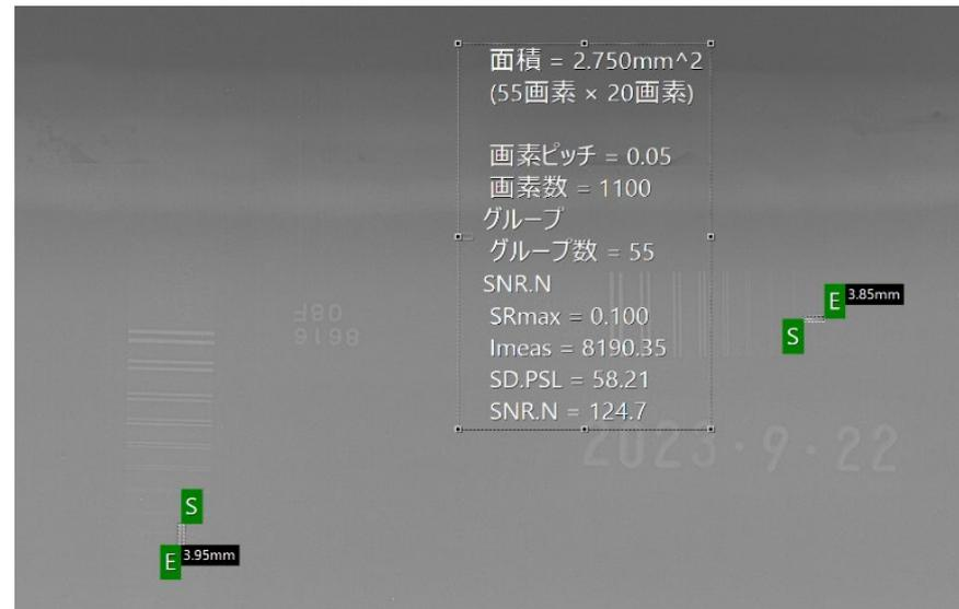
TP-2 板厚28.0mm x 38.0mm D-RT (CR)  $SNR_N$ 測定
