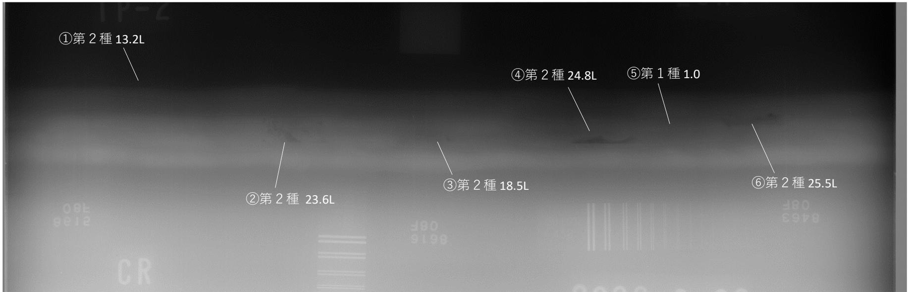
TP-2 板厚 28.0mm x 38.0mm 突合せ溶接試験片 D-RT (CR【IP】)
