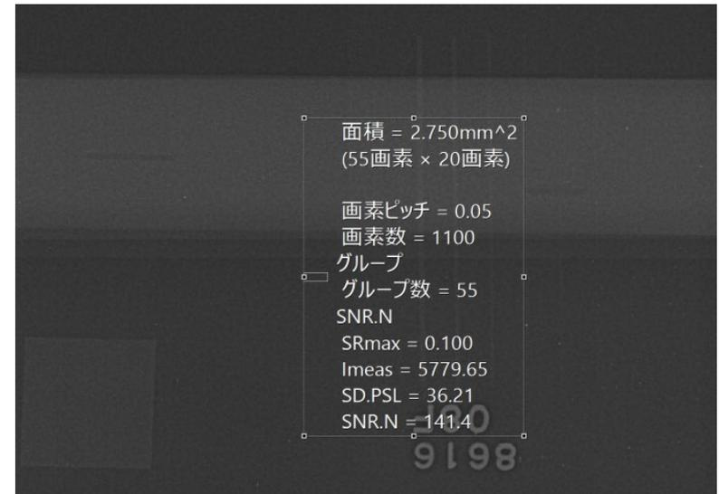
TP-1 板厚20.0mm D-RT (CR) SNR<sub>N</sub>測定
