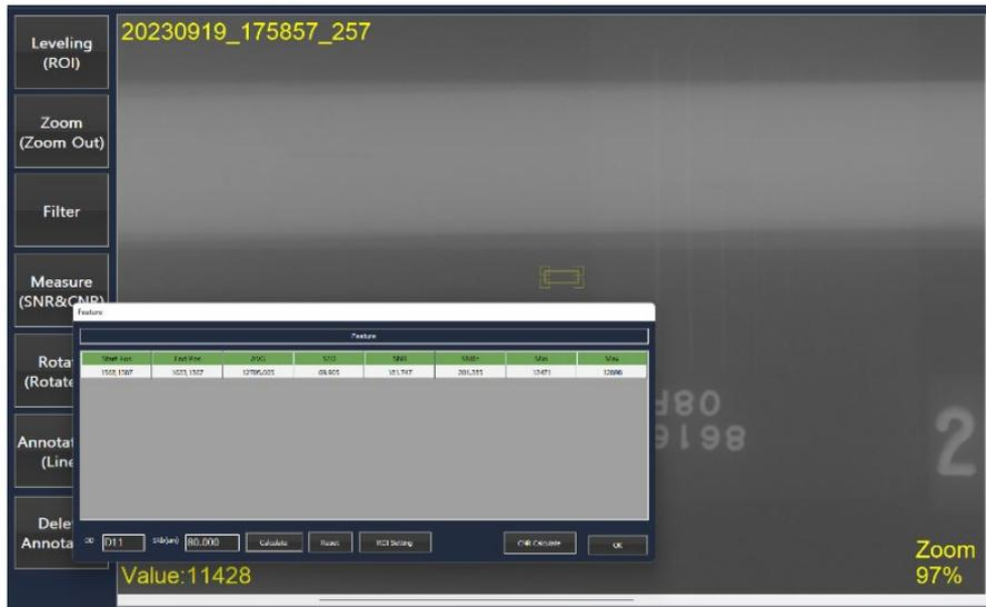
TP-1 板厚20.0mm D-RT (DDA) SNR<sub>N</sub>測定
