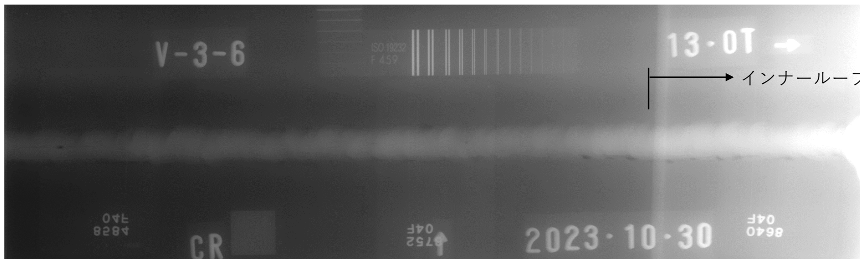
⑧ 板厚 13.0mm 側板相互突合せ溶接 D-RT (CR【IP】)
