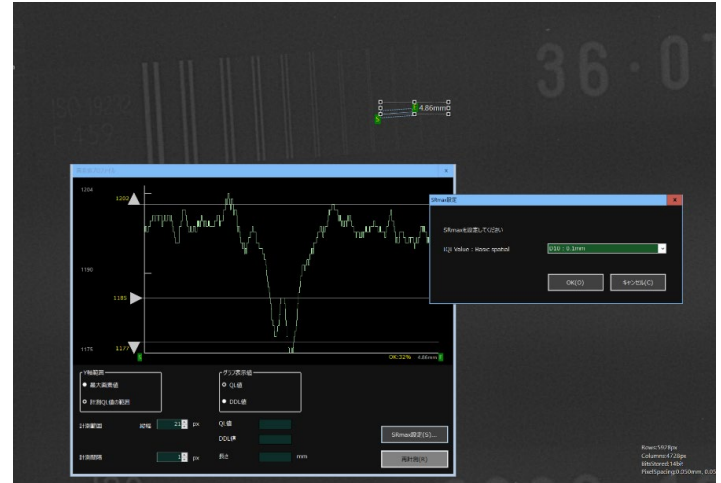
板厚 36.0mm D-RT (CR) 複線形像質計 確認例
