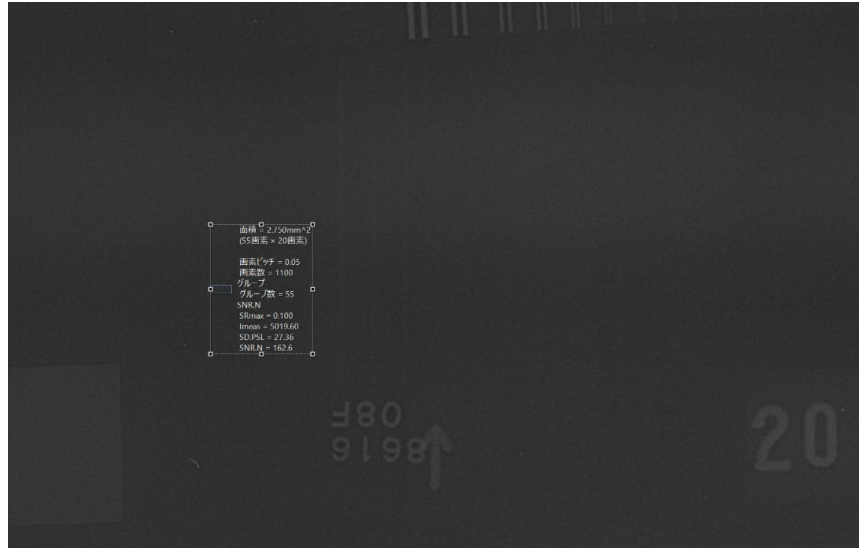
板厚 36.0mm D-RT (CR) SNR n 確認例
