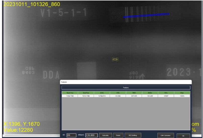
板厚 36.0mm D-RT (DDA) SNR n 確認例
