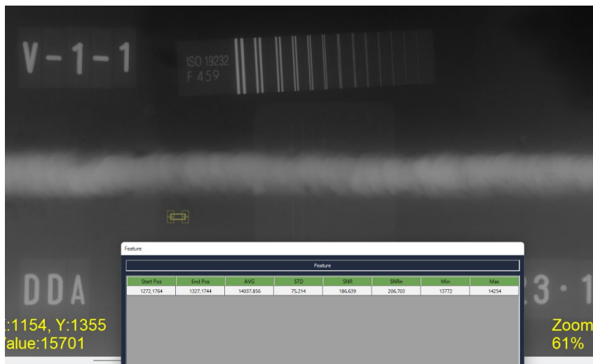
板厚 13.0mm D-RT (DDA) SNR n 確認例
