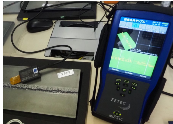
写真5 -フレキシブル型プローブによる探傷例
