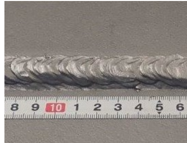
写真8 -隅肉溶接試験片の例 (手動溶接・不均一な仕上り)
