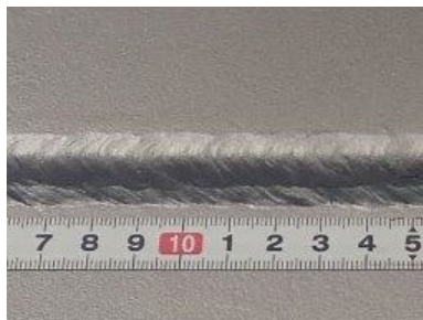
写真7 -隅肉溶接試験片の例 (手動溶接・均一な仕上り)
