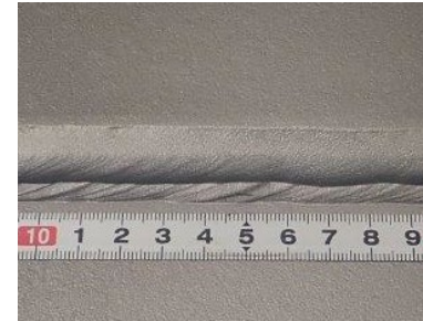
写真9 -隅肉溶接試験片の例 (自動溶接・均一な仕上り)
