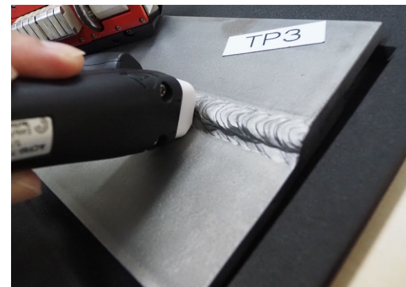
写真6 -隅肉溶接用ペン型プローブによる探傷例
