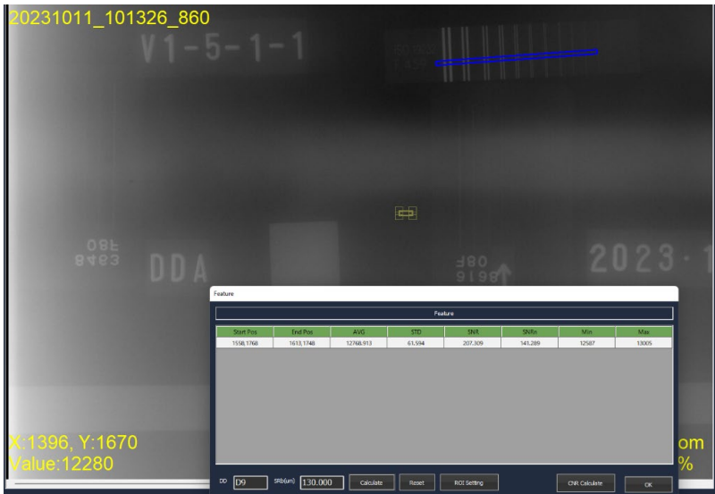
板厚 36mm D-RT (DDA) SNR N 確認例
