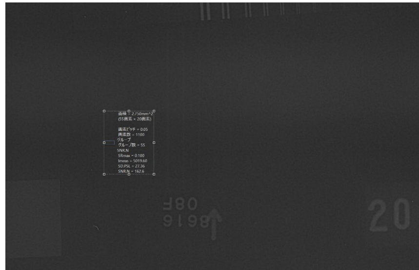
板厚 36mm D-RT (CR) SNR N 確認例
