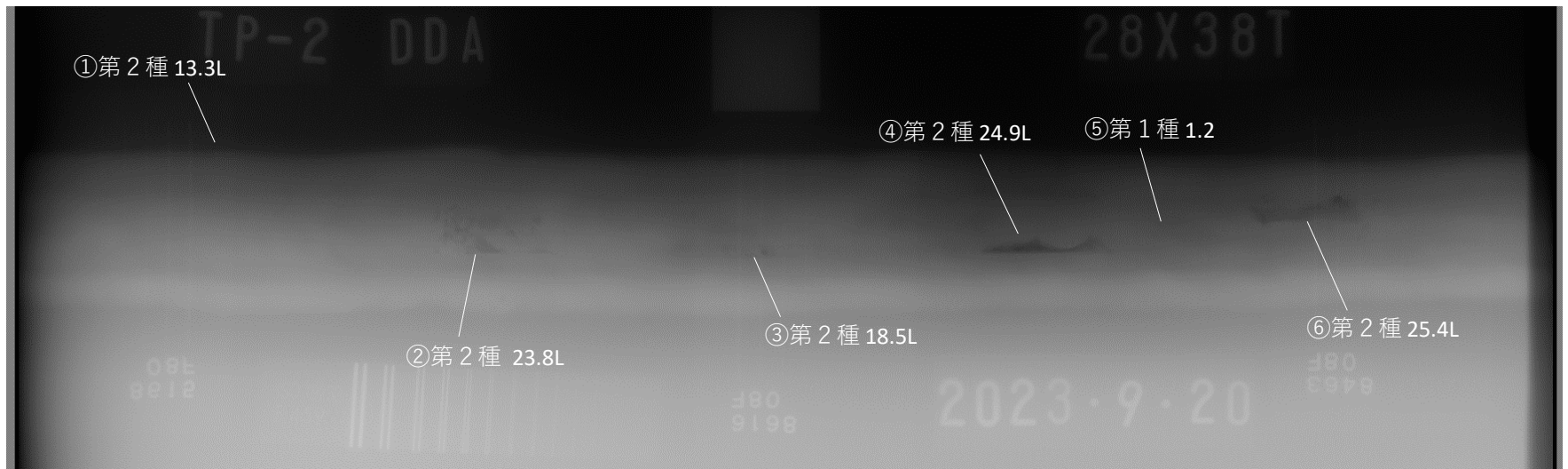
TP-2 板厚 28mm x 38mm 突合せ溶接試験片 D-RT (DDA)
