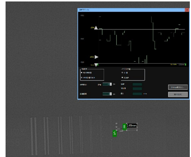
TP-1 板厚 45mm D-RT (CR) 複線形像質計
