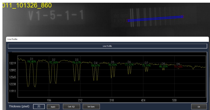
板厚 36mm D-RT (DDA) 複線形像質計 確認例
