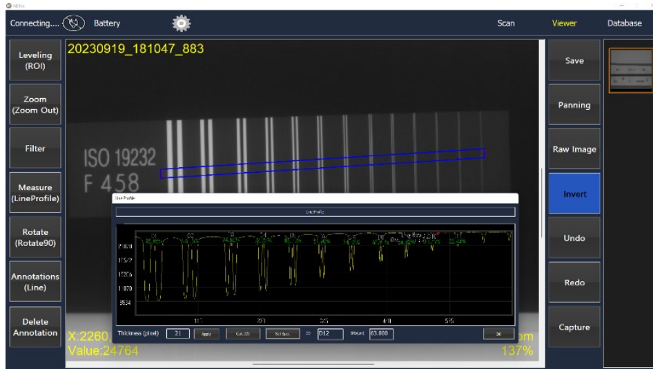
TP-1 板厚4.5mm D-RT (DDA) 複線形像質計
