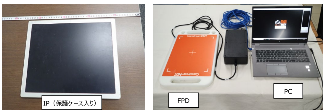
図 2-3 CR システムで用いられる IP (左) 及び DDA システム (右)
