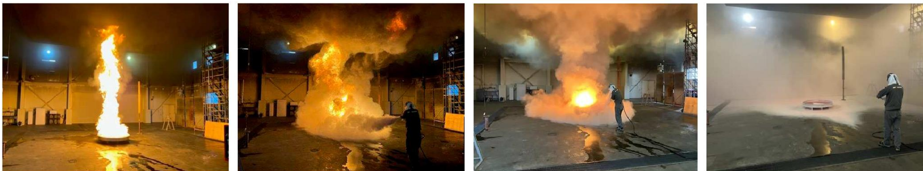
画像：移動式粉末消火設備を用いた2m 2 オイルパンの消火試験の様子（提供：モリタ宮田工業(株)）
