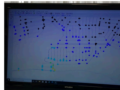
【解析ツール（PIPE-mini Win 管網解析シミュレーションシステム）を用いた検証】
