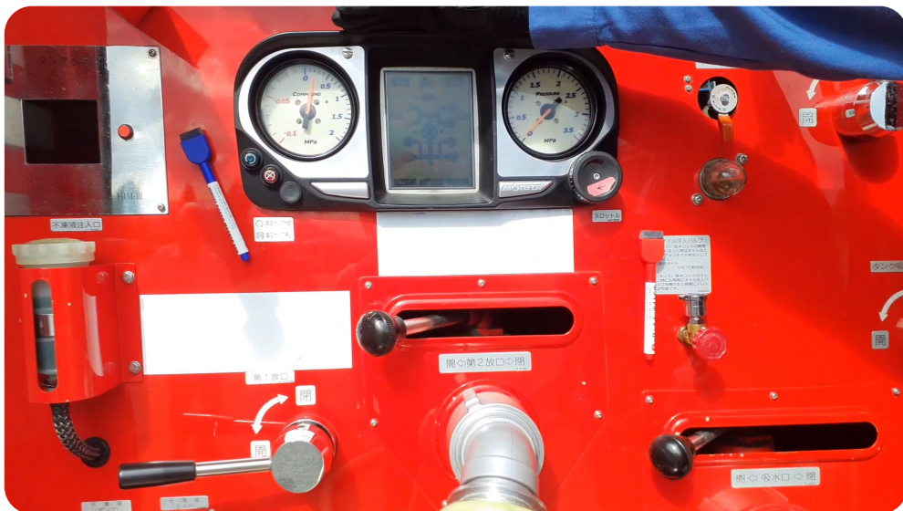
【消防車両の「流量計」の計測状況】
