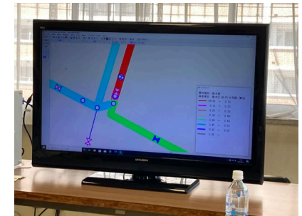
【解析ツール（PIPE-mini Win 管網解析シミュレーションシステム）を用いた検証】
