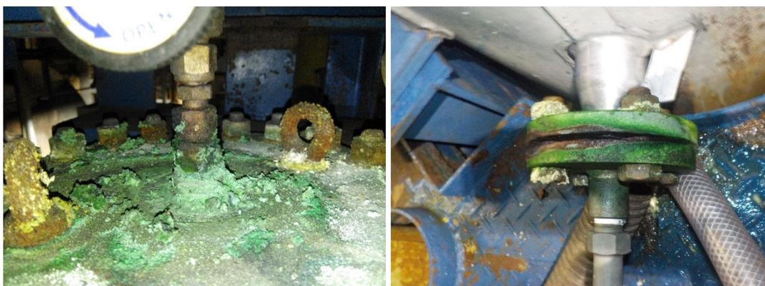
写真8-3-2 フッ化水素の漏えい痕（金属の腐食による結晶物）
