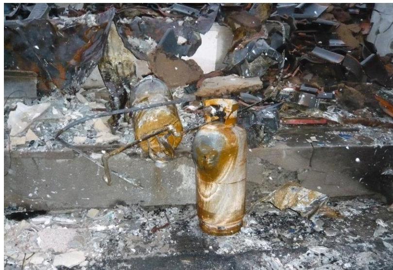
加熱で変形・亀裂の生じた家庭用プロパンガスボンベ
