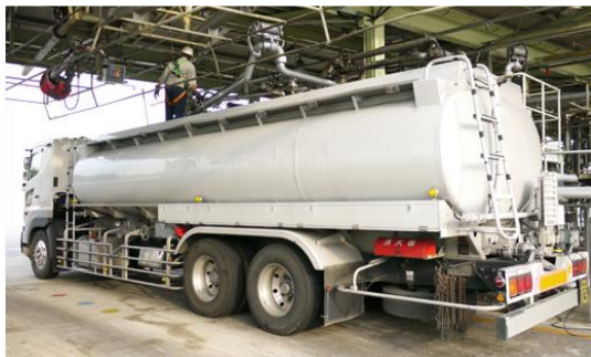
トップローディング方式による充てんの例
