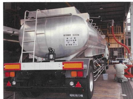
ボトムローディング方式による充てんの例
