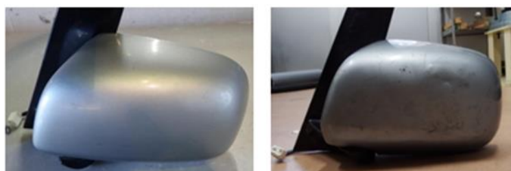
図 12 実験後のミラーの状況 (水成膜泡消火薬剤)
