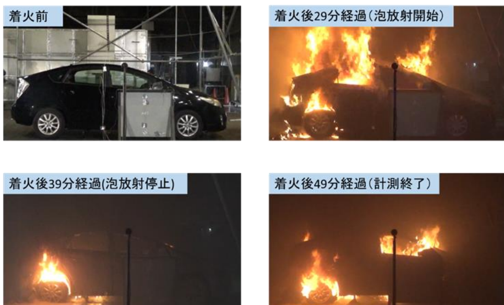
図7 実験実施状況（合成界面活性剤泡消火薬剤：令和6年度実施時）
