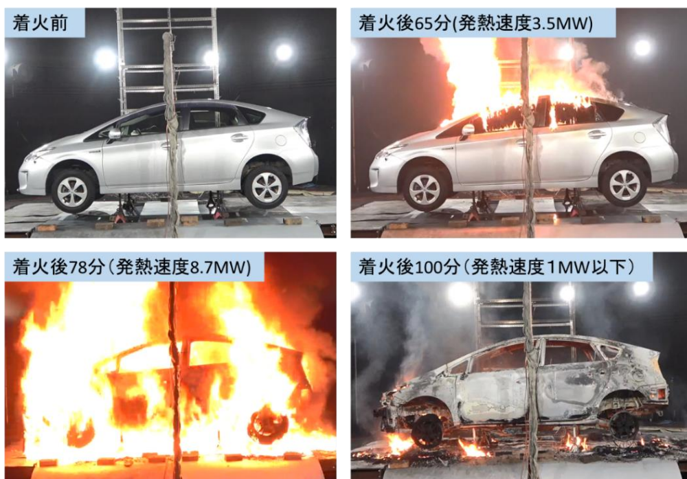
図 5-2 実験実施状況 (A 火災：令和 6 年度実施時)
