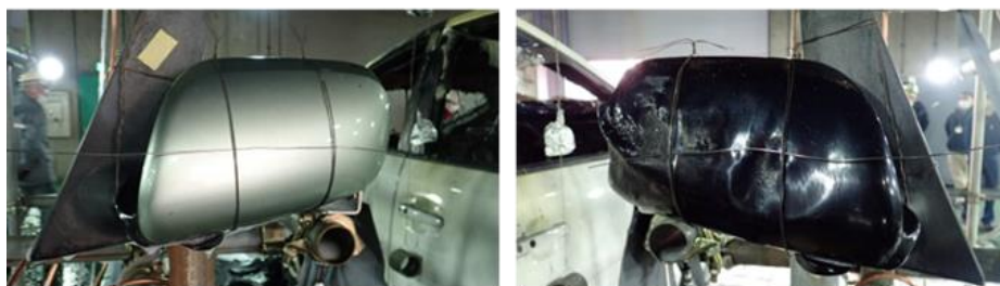
図6 実験後のミラーの状況（水成膜泡消火薬剤：令和4年度実施時）
