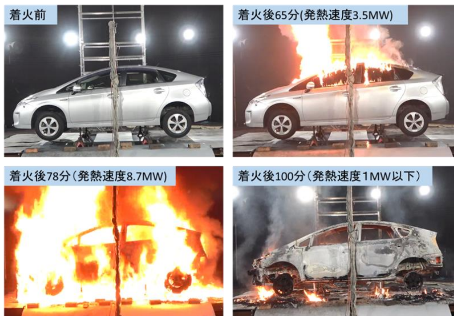
図3 実験実施状況 (A 火災：令和6年度実施時)
