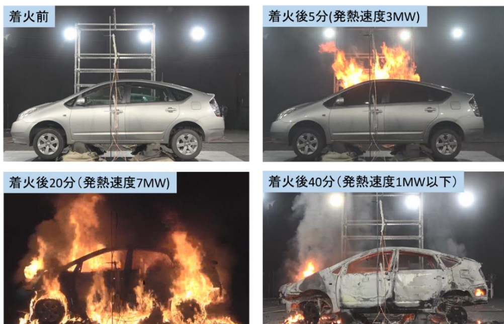
図5-1 実験実施状況 (A 火災：令和2年度実施時)
