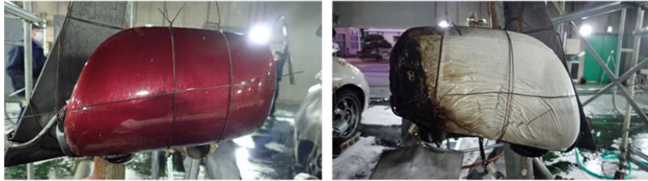
図 10 実験後のミラーの状況（令和 6 年度実施時・B 火災）
