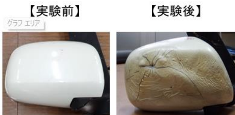
図 21 実験前後のミラー状況（B 火災模型・合成界面活性剤泡消火薬剤）
