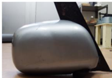
図 14 実験後のミラーの状況（合成界面活性剤泡消火薬剤）
