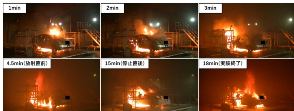
図 7 実験実施状況（令和 4 年度実施時：B 火災・水成膜泡消火薬剤）
