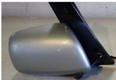
図 14 実験後のミラーの状況（合成界面活性剤泡消火薬剤）
