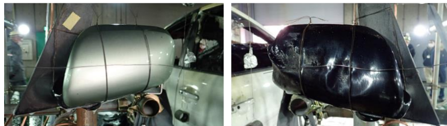
図 6 実験後のミラーの状況（令和 4 年度実施時・A 火災）
