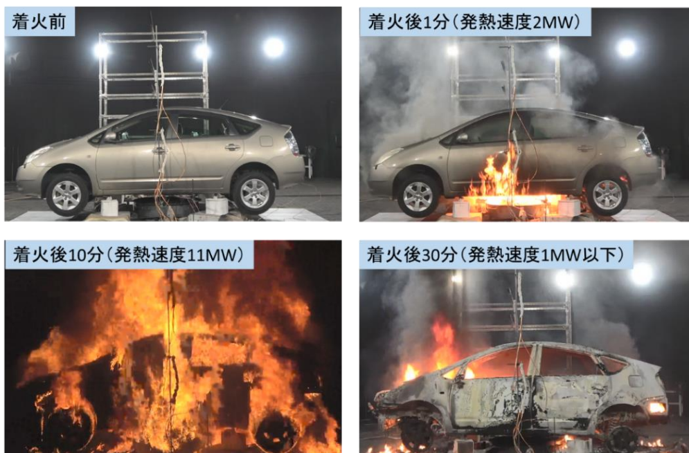
図 9-1 実験実施状況 (B 火災：令和 2 年度実施時)
