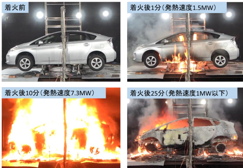
図 9-2 実験実施状況 (B 火災：令和 6 年度実施時)
