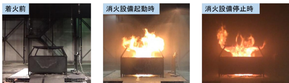
図 18 実験実施状況 (B 火災模型・合成界面活性剤泡消火薬剤)
