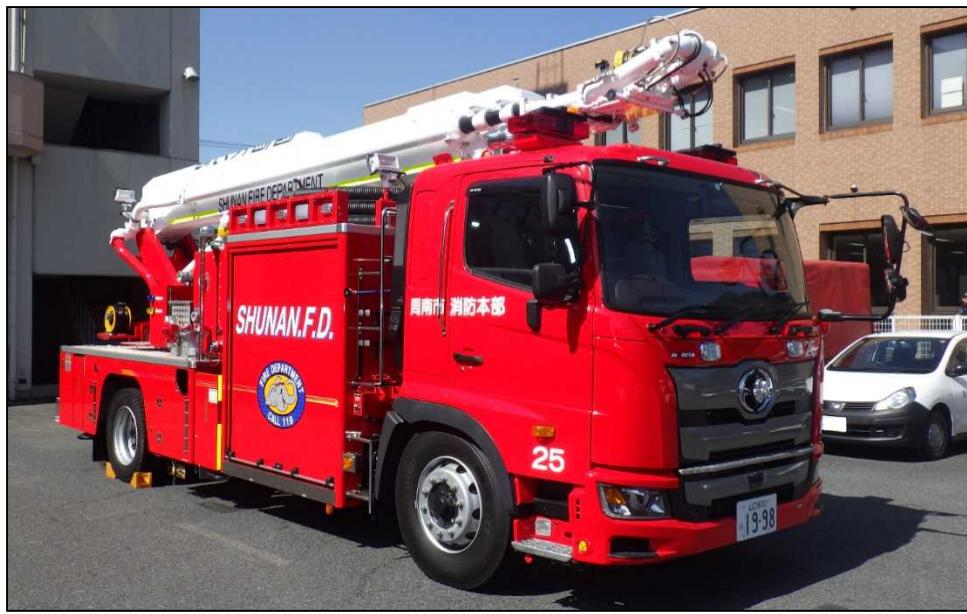
写真7-1-4 大型化学高所放水車
