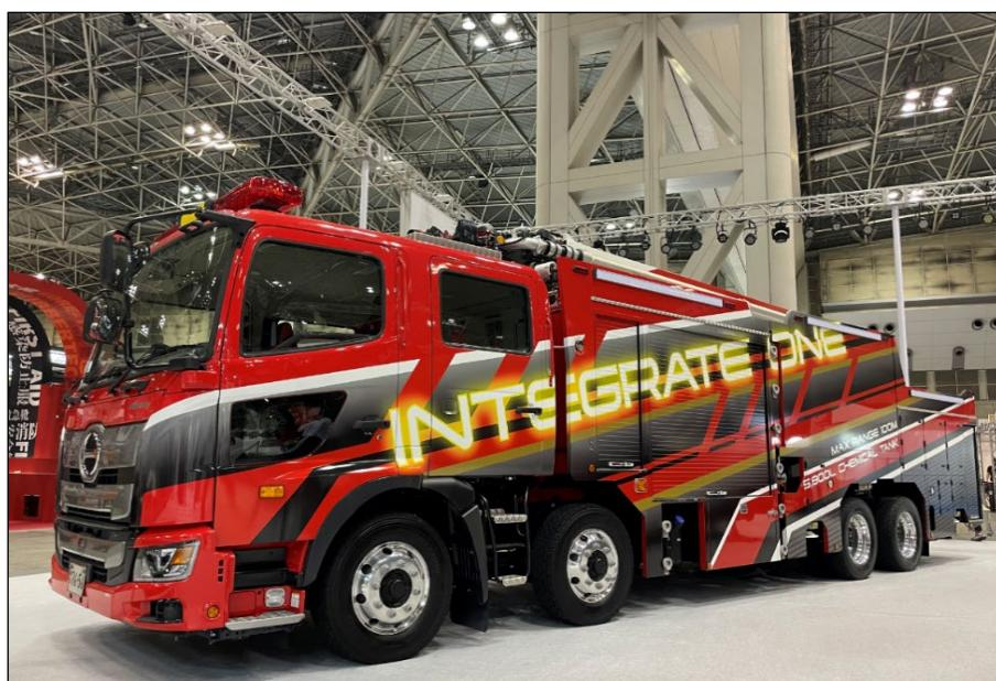
写真7－1－5 消火薬剤タンク付き大型化学高所放水車
