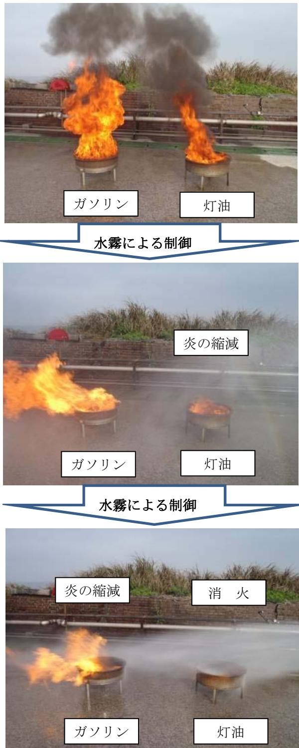
消火活動は、後者の水霧放水で、消火隊の隊員を輻射熱から保護し、かつ、火元に接近し、水霧放水で「炎」を縮減し、粉末消火器で「消炎」して、水で燃焼界面を「冷却」することが有効です。
