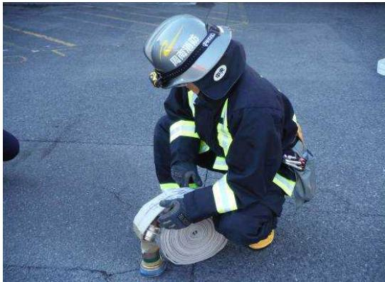
完成した二重巻き消防用ホースは、オス金具とメス金具との間隔が20cm～30cm取るのが、肩に担いだときに金具が固定でき、かつ右足先でメス金具近くを踏み、オス金具を手で持ってひろげるのに適当です。
