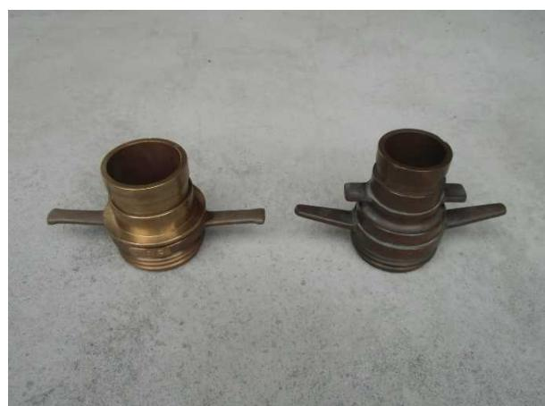
写真7-9-2 媒介金具（左側が75mm、右側が65mm）
