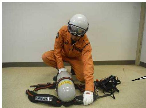
⑥指揮者の「本体着装」の号令で右手でそく止弁付近の保護枠を持ち、左手で背負いバンドの上部を持ちます。
