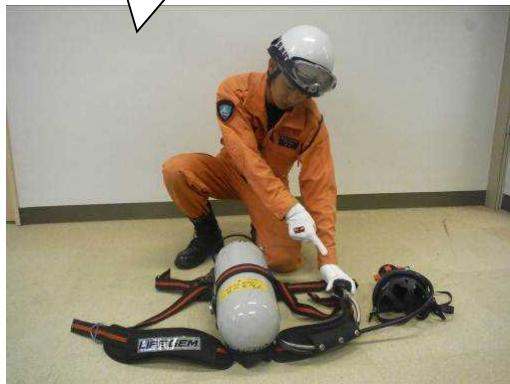
④着装用意、呼気弁の点検をします。
