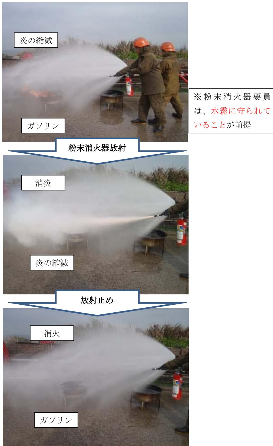
危険物を取り扱っている事業所の自衛防災組織の要員等が、修得しなければならない基本的な知識が「連鎖反応」で、技能が「水霧放水と粉末消火器」による消火戦術です。
