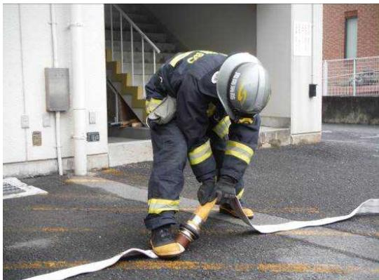
結合した後、右足でオス金具の根元を踏んだ状態で、両手で消防用ホースを引っ張り、結合状態を確認します。
