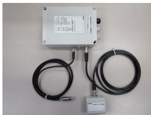
IoTセンサ (写真は圧力センサと振動センサを接続)
