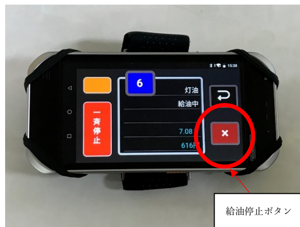
図3 可搬式の制御機器（給油中）
