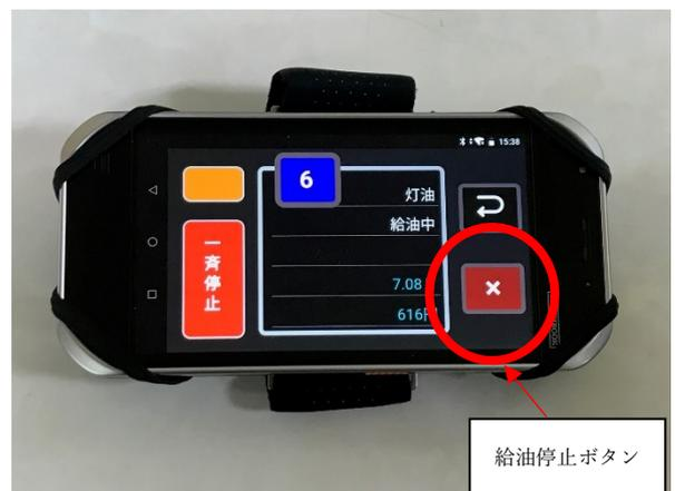
図3 可搬式の制御機器 (給油中)
