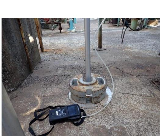
写真10 床面に設置した可燃性ガス検知器
