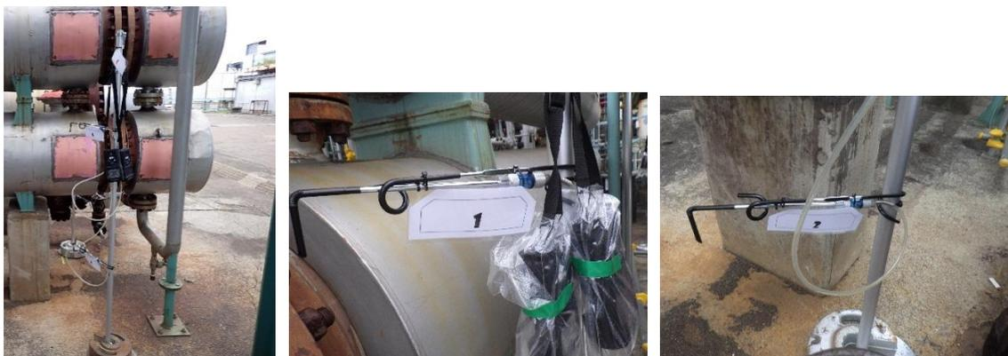
写真6 自立ポール① 写真7 ガス検知器①-1 写真8 ガス検知器①-2
