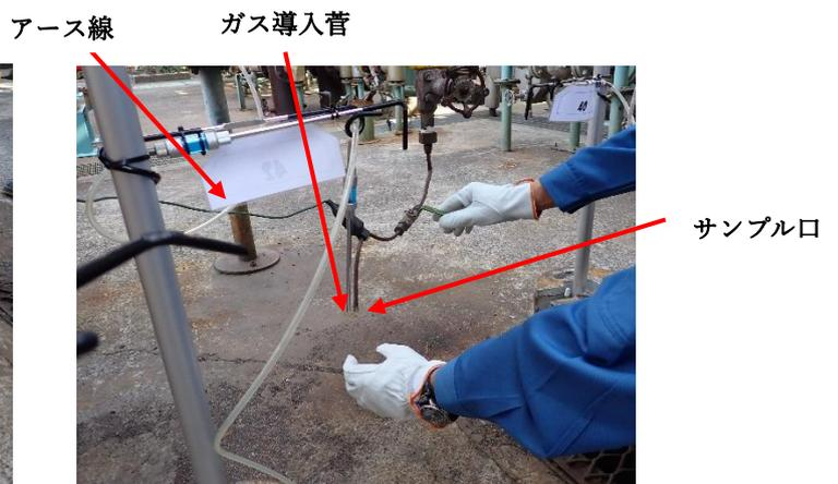
写真11 サンプル吐出口での測定
