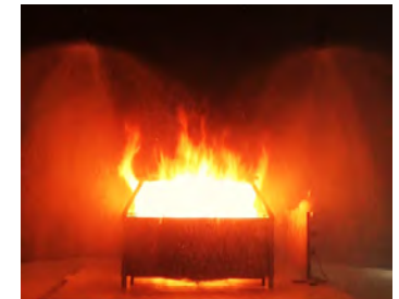
車両の燃焼ピークを再現した簡易模型の消火実験の様子
