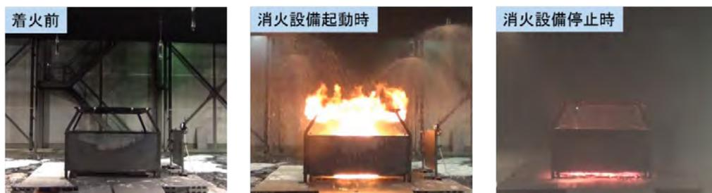
図8 実験実施状況（A火災模型・合成界面活性剤泡消火薬剤）
