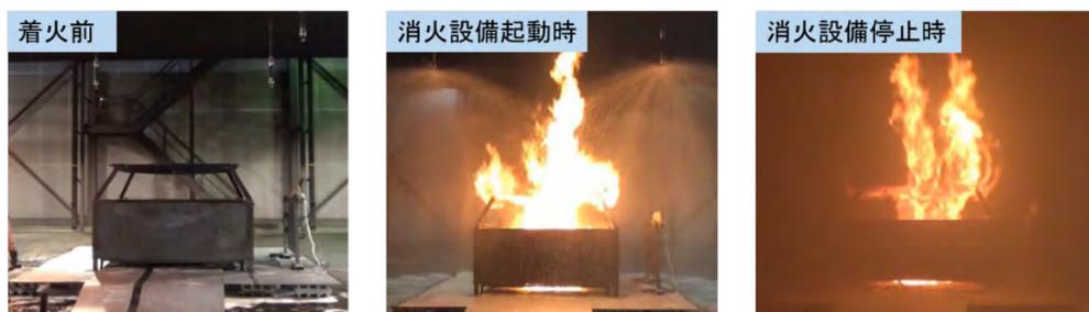
図 12 実験実施状況 (B 火災模型・水成膜泡消火薬剤)
