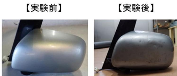
図 12 実験後の隣接車両位置のミラーの状況（水成膜泡消火薬剤）
