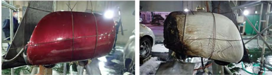
図 10 実験後のミラーの状況（令和 6 年度実施時・B 火災）
