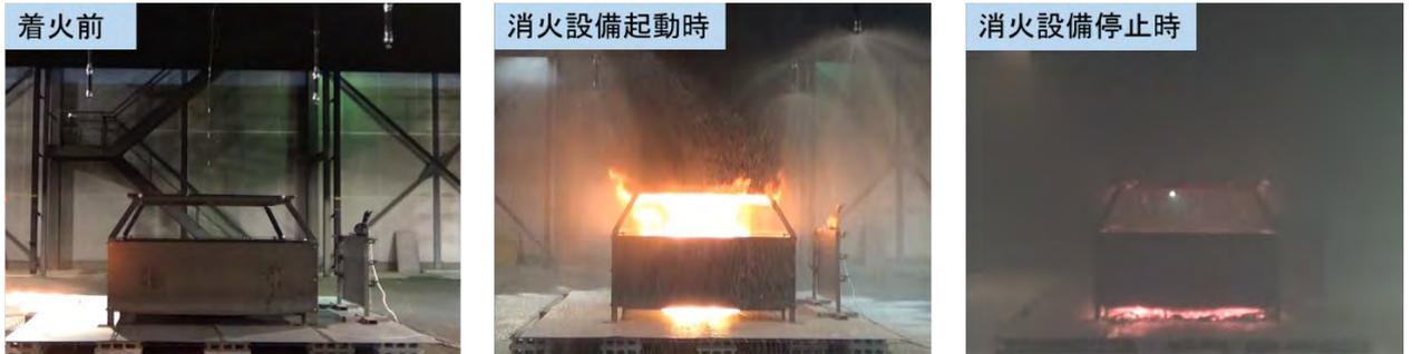
図2 実験実施状況 (A火災模型・水成膜泡消火薬剤)
