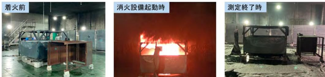
図 22 実験実施状況 (A 火災・水成膜泡消火薬剤)
