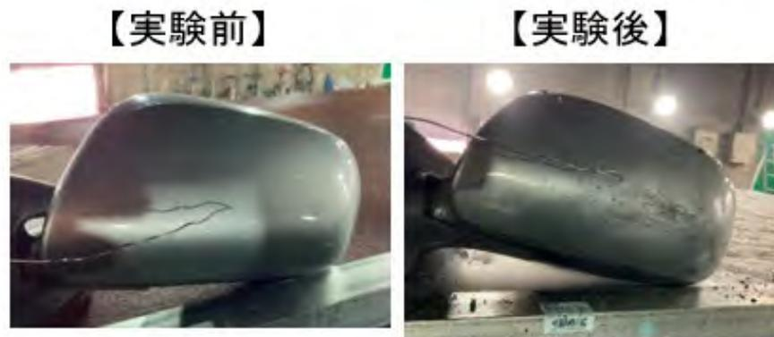
図 27 実験前後のミラー状況 (A 火災模型・水成膜泡消火薬剤)
