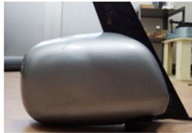
図 14 実験後の隣接車両位置のミラーの状況（合成界面活性剤泡消火薬剤）
