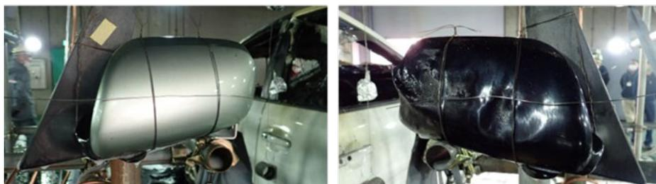
図6 実験後の隣接車両位置のミラーの状況（水成膜泡消火薬剤：令和4年度実施時）
