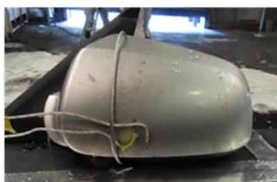
図8 実験後の隣接車両位置のミラーの状況（合成界面活性剤泡消火薬剤：令和6年度実施時）
