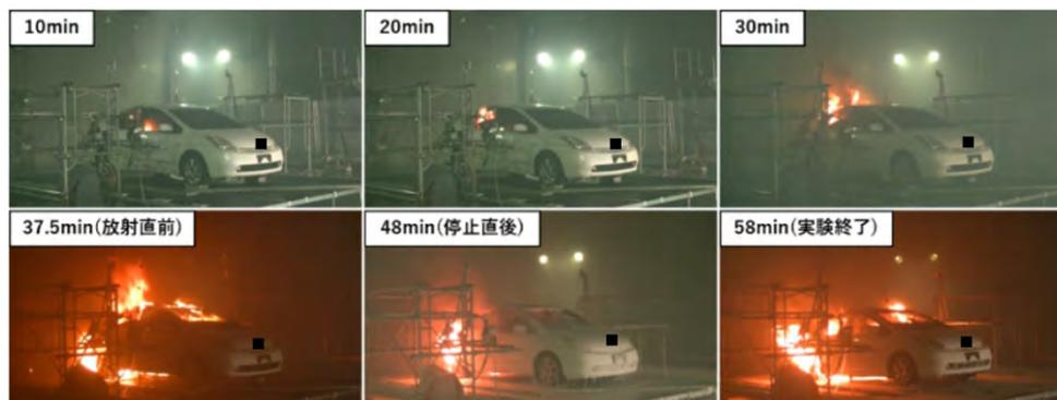
図3 実験実施状況（令和4年度実施時：A火災・水成膜泡消火薬剤）
