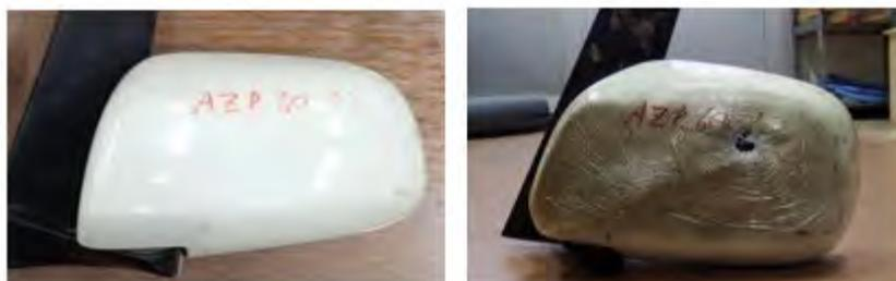
図 17 実験前後のミラー状況 (B 火災模型・水成膜泡消火薬剤)
