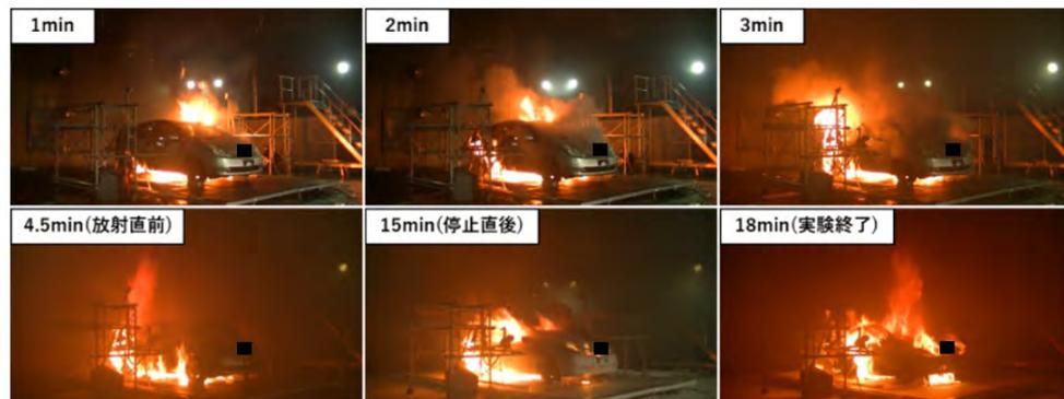
図7 実験実施状況（令和4年度実施時：B火災・水成膜泡消火薬剤）
