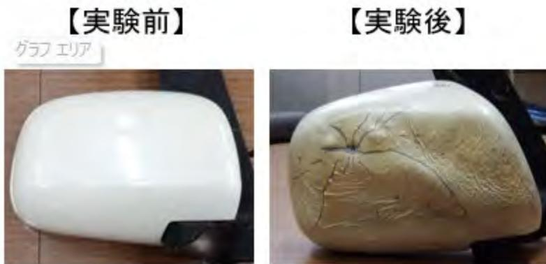
図 21 実験前後のミラー状況 (B 火災模型・合成界面活性剤泡消火薬剤)
