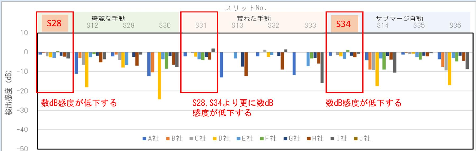
図 溶接部の形状及びきずの位置による検出性確認試験結果
