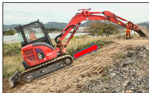
【180° 旋回での登坂】※傾斜角度 27°
