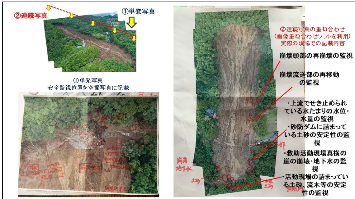
【2019年東日本台風における神奈川県相模原市牧野の崩壊の写真地図への記載例】
