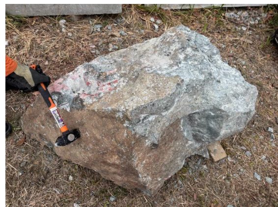
(岩石が地面に設置していない全ての面をハンマーで打撃し、音、反発の変化を確認)
