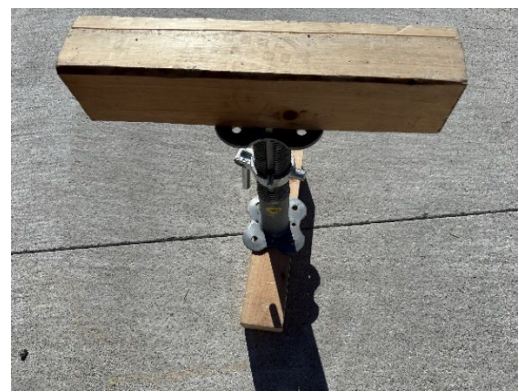
【失敗例：計測に合わせず木材をセット】
