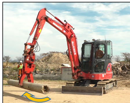
【電柱持ち上げ旋回例】
