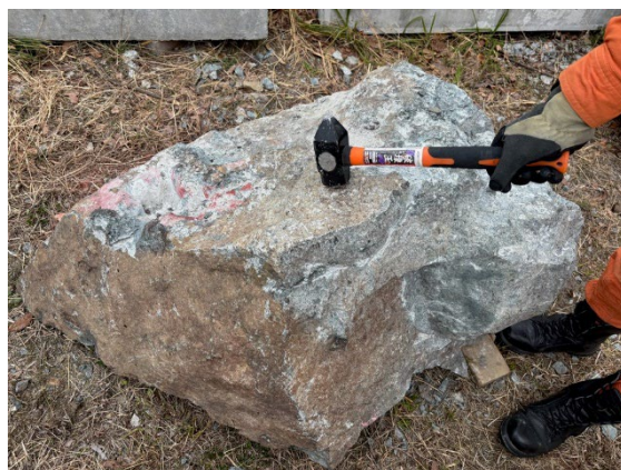
(岩石が地面に設置していない全ての面をハンマーで打撃し、音、反発の変化を確認)
