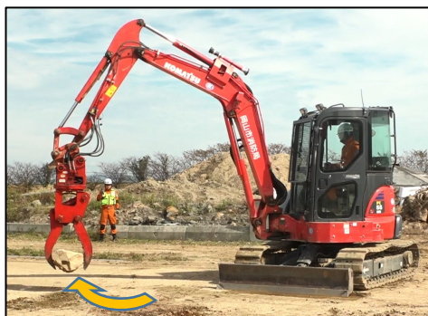
【瓦礫持ち上げ旋回例】
