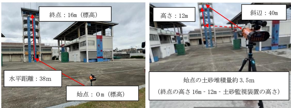
※ 土砂が堆積した始点（車上で再現）から斜辺を測り、堆積量を算出
