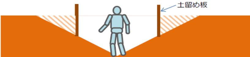
応急土留めを設定することで斜線部分は掘削しないので排出する土砂量が減り、
