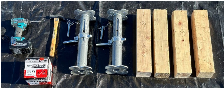
【パイプサポート設定資機材】
