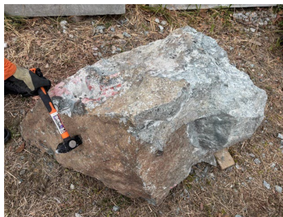
(岩石が地面に設置していない全ての面をハンマーで打撃し、音、反発の変化を確認)
