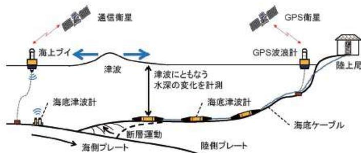
図2 沖合で津波を観測監視する機器と仕組み
