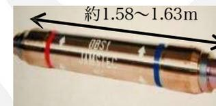
海底地震計（ケーブル式海底地震計）
