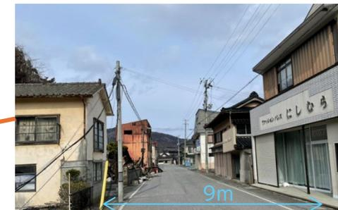
道路の隔離距離による焼けどまり。向かいの建物への消火活動(上図)も延焼阻止要因。
