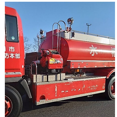
可搬ポンプの積載状況
