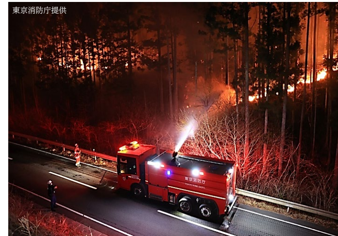
放水銃を搭載した大型水槽付消防車による放水
