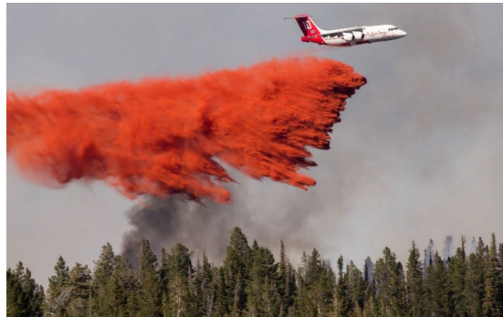
延焼防止剤を固定翼機から空中散布
