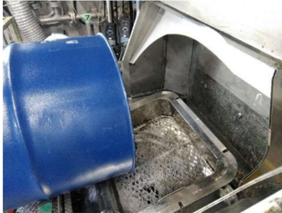
【図 15 原料ドラムからの投入状況】
