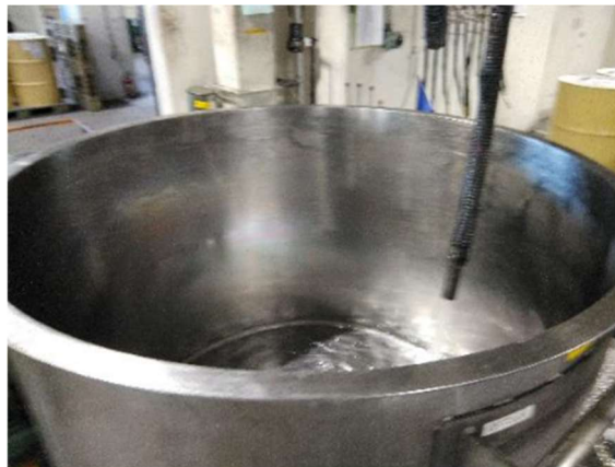
【図33 配管からの原料危険物の投入状況】
