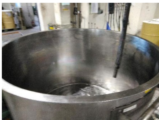
配管からの原料危険物の投入状況
