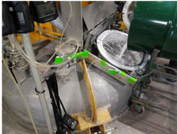
【図9 原料ドラムからの投入状況】
