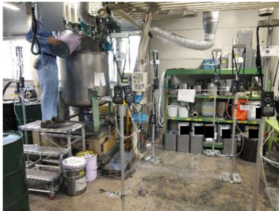
【図37 容器からの原料危険物の投入状況】
