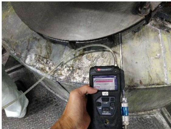
【図 24 投入口の蓋接合部付近の測定状況】
