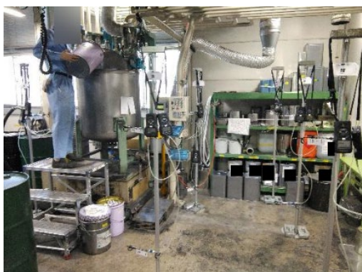
容器からの原料危険物の投入状況
